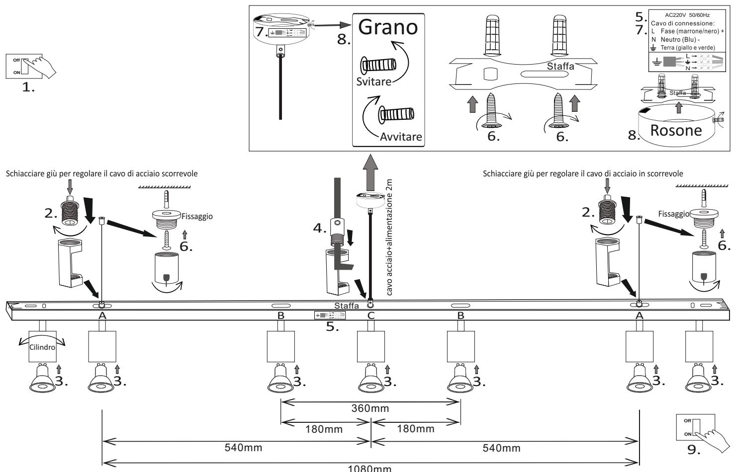
**1.** Prima di installare o sostituire la lampada, disattivare l'energia elettrica.
